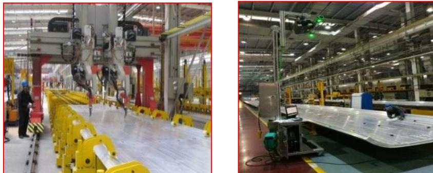
图 2 雅万高铁制造采用搅拌摩擦焊等绿色低碳制造技术
