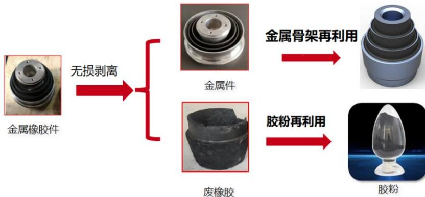
图 8 橡胶件的循环再制造
