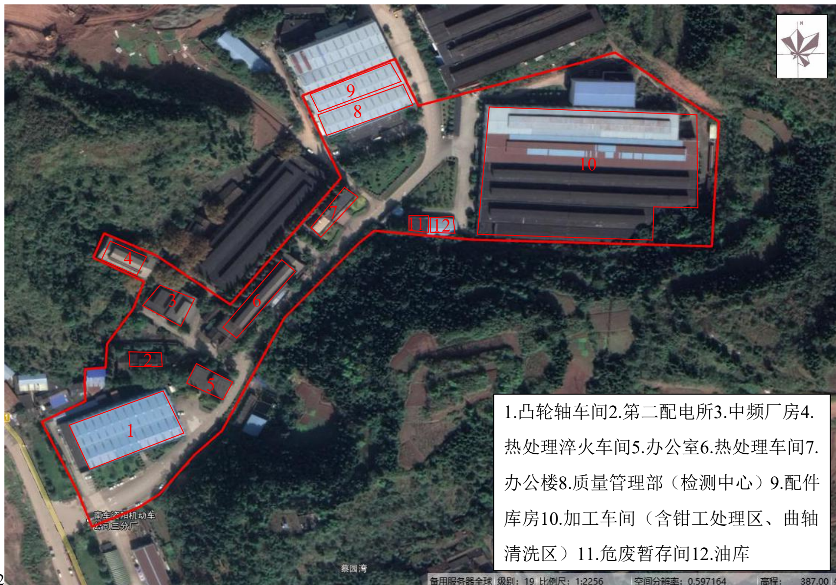
图2.5-2 曲轴分公司（包括质量管理部（检测中心））平面布置图
