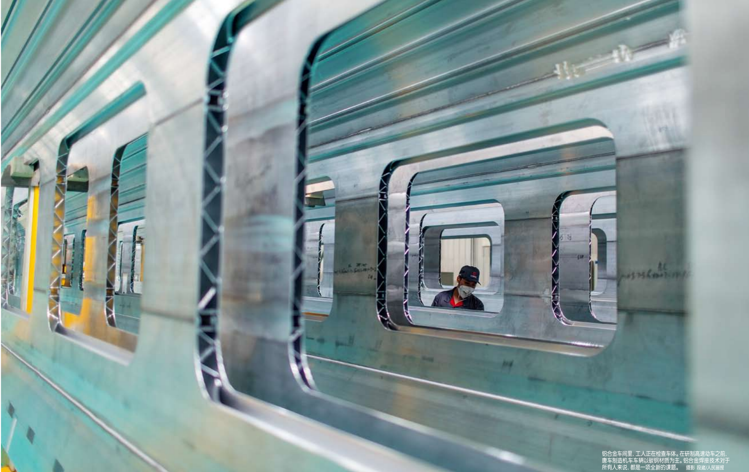
预组装车间里，工人正在为土耳其伊兹密尔市订购的地铁车辆安装车窗玻璃。 摄影 段威/人民画报
