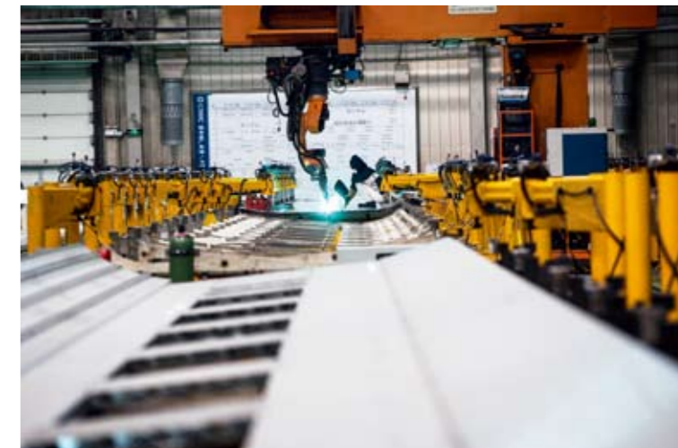
铝合金车间里，工人正在利用焊接机器人进行铝合金车体焊接。 摄影 陈建/人民画报
